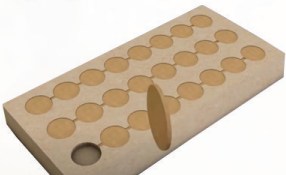
(1) உருக்கப்பட்ட உலோகம் வட்ட அச்சுக்களில் ஊற்றப்பட்டு வட்ட உலோகத் துண்டுகள் பெறப்படும்
